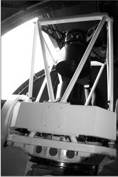
Рис. 2. Альт-азимутальне монтування телескопа, виготовлене компанією ElectroOpticsSystems (Канберра, Австралія)
