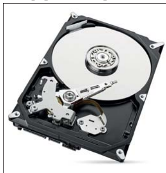
Жорсткий диск (вінчестер) – пристрій для зберігання даних
