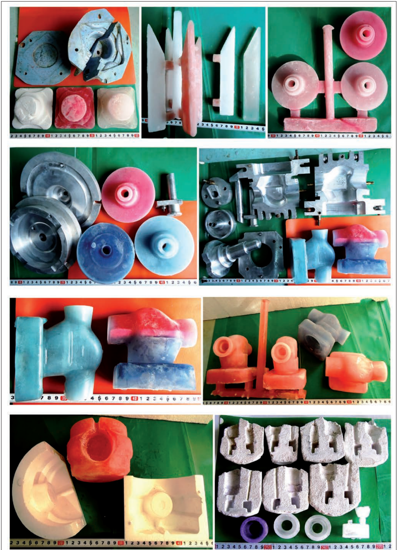
Рис. 2, б. Фотографії льодяних моделей, прес-форм для їхнього отримання, оболонкових форм і виливків, розроблених у Фізикотехнологічному інституті металів і сплавів НАН України
