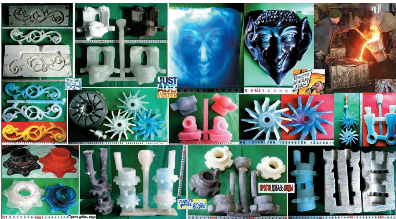
Рис. 3, а. Льодяні моделі, піщані оболонки, виливки з чорних і кольорових металів за льодяними моделями
