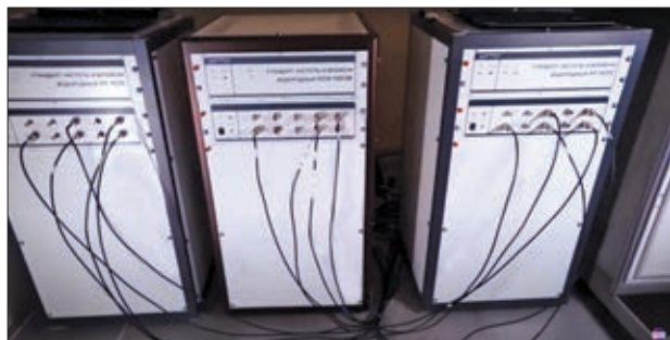
Рис. 1. Груповий еталон частоти і часу радіоастрономічної обсерваторії на основі трьох водневих стандартів частоти Ч1-1035
