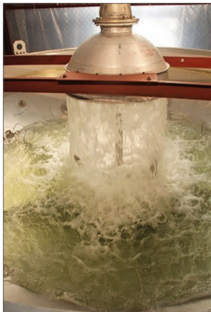
Рис. 2. Фото процесу наповнення дослідних конструкцій M_1 1:1 модельною рідиною (водою)
