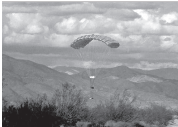
Рис. 2. Парашан з подвійною обшивкою [20]
