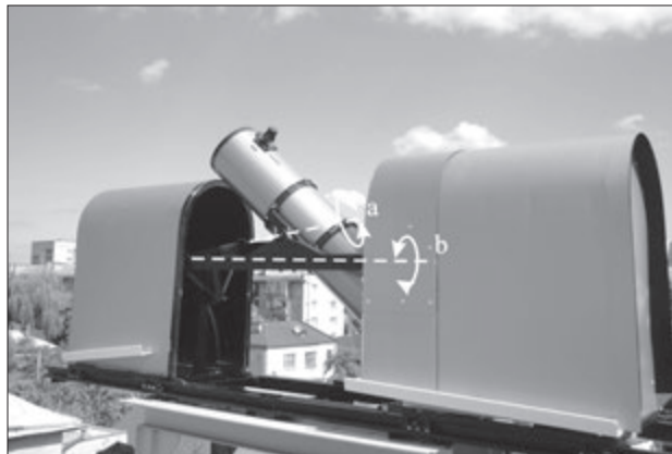
Рис. 11. Телескоп SkyWatcher BK-305/1500 OTA, custom AltAz mod на альт-альт-монтуванні (Рівненська Мала академія наук учнівської молоді)
