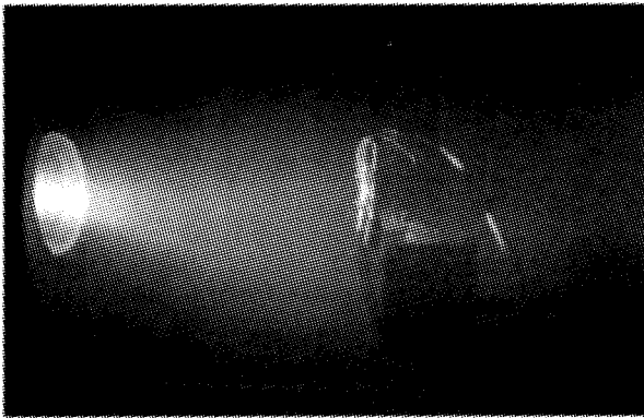
Рис. 4. Термостат с образцами испытуемых материалов в потоке плазмы атомарно-молекулярного кислорода
